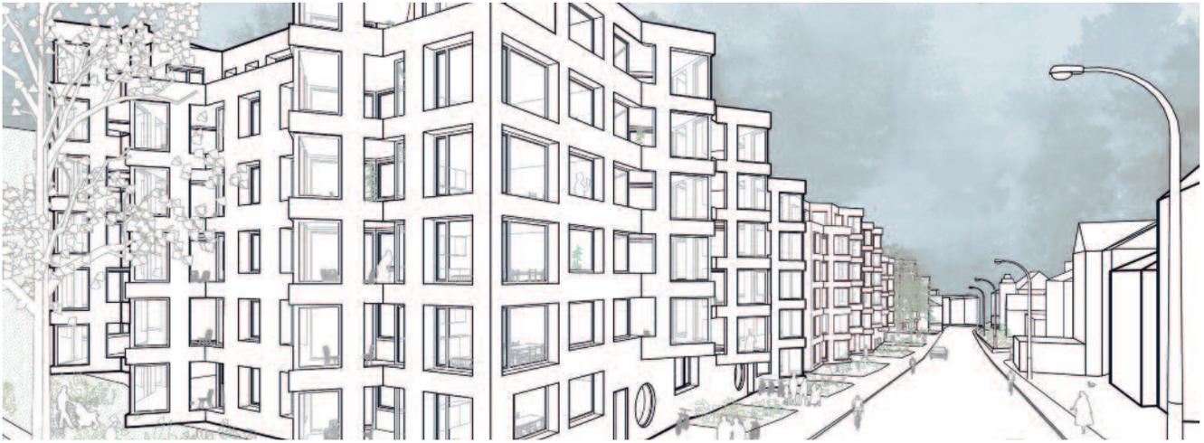
Visualisierung des Konstruktionsprinzips mit den lärmschützenden Grosserker.
